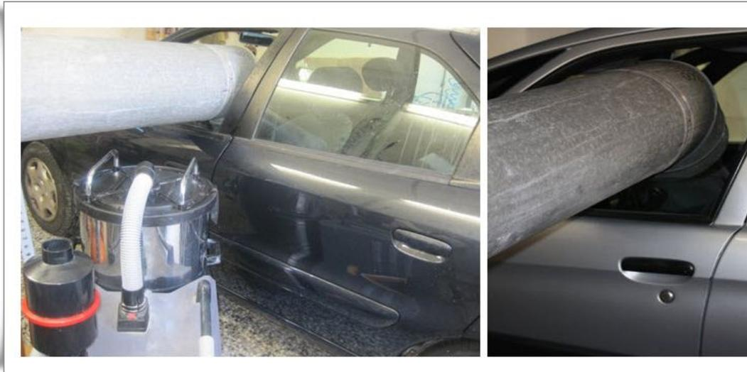
El servicio secado interior de vehículos, se efectúa para quitar las humedades del interior del vehículo y evitar los posibles olores desagradables y condensaciones de humedad del interior del vehículo
